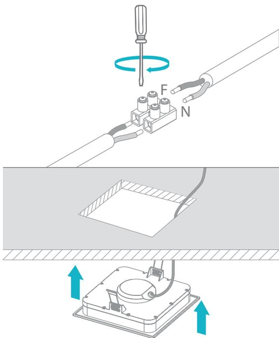
Conecte os cabos de alimentação do Painel Deep à rede elétrica.
